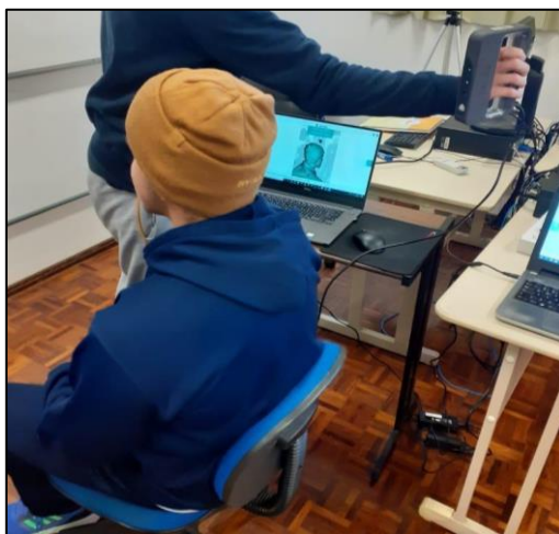
Figura 5: Captura de objeto (cabeça do estudante) com scanner.
