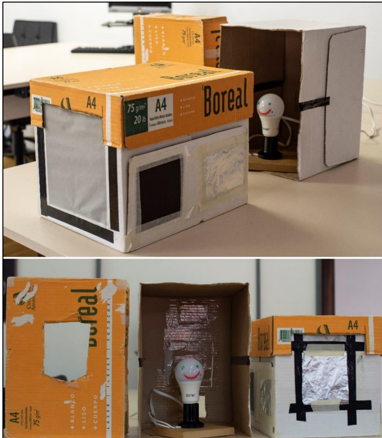
Figura 1: Acima. A câmara escura. A parte frontal da caixa é recortada e retirada, e um papel vegetal é colado aí. Mais atrás, aparece a fonte de luz, dentro de uma segunda caixa. Abaixo. A fonte de luz, dentro da caixa, com sua tampa retirada, à esquerda. À direita, aparece a parte traseira da caixa, na qual foi recortada uma janela, que está oculta pela lâmina de alumínio. É no centro desta lâmina que será feito o orifício, com uma agulha.
