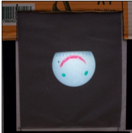
Figura 2: Imagem, obtida a partir uma foto com grande tempo de exposição (4 s, ISO 400, abertura f 1:1.4). A lâmpada (objeto) está na posição direita (na vertical, soquete para baixo), a imagem (foto) aparece invertida.
