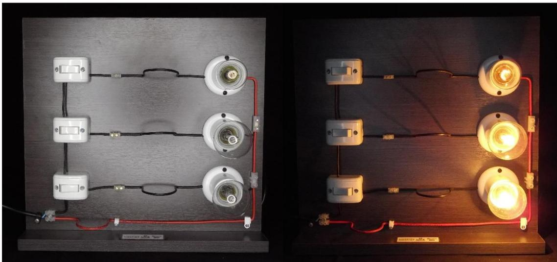
Figura 3: Face do painel onde três lâmpadas (apagadas na imagem da esquerda e acesas na da direita) estão conectadas em paralelo.
