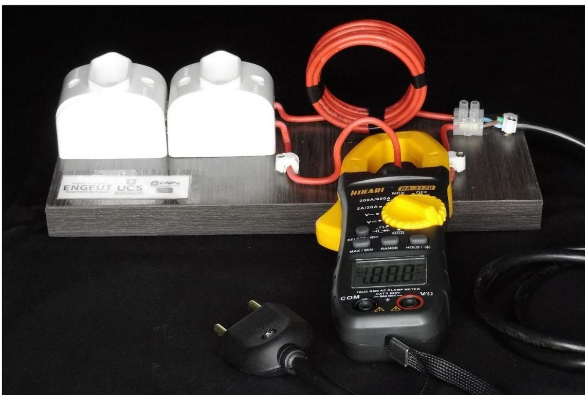
Figura 2: Tomada para a medição da potência de diferentes dispositivos elétricos.
