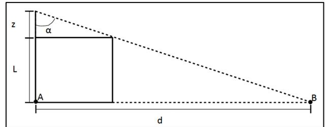
Fig. 8: Desenho esquemático do uso do equipamento de medição (linhas sólidas) para a determinação da distância  $d$  entre  $A$  e  $B$  (alvo). O comprimento  $z$  é determinado ajustando a lente móvel do equipamento.
