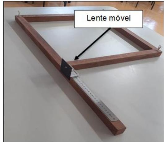
Fig. 4: Posicionamento da lente móvel (um orifício na placa preta) colocada no equipamento de medição.
