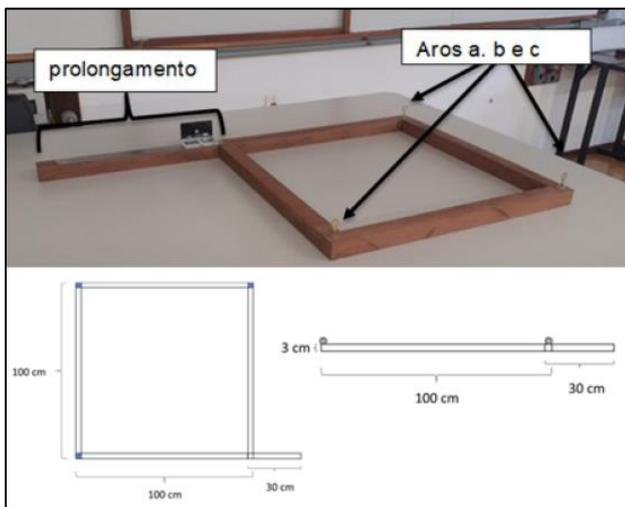
Fig. 3: Topo: equipamento de medição. Embaixo: dimensões do equipamento de medição em vista superior (à esquerda) e lateral (à direita).
